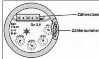
Die Zählernummer ist entweder oben unter dem Deckel, auf dem Messingring oder auf dem Glas zu erkennen. Darunter steht der Zählerstand. Die Drehzeiger bitte nicht ablesen!
